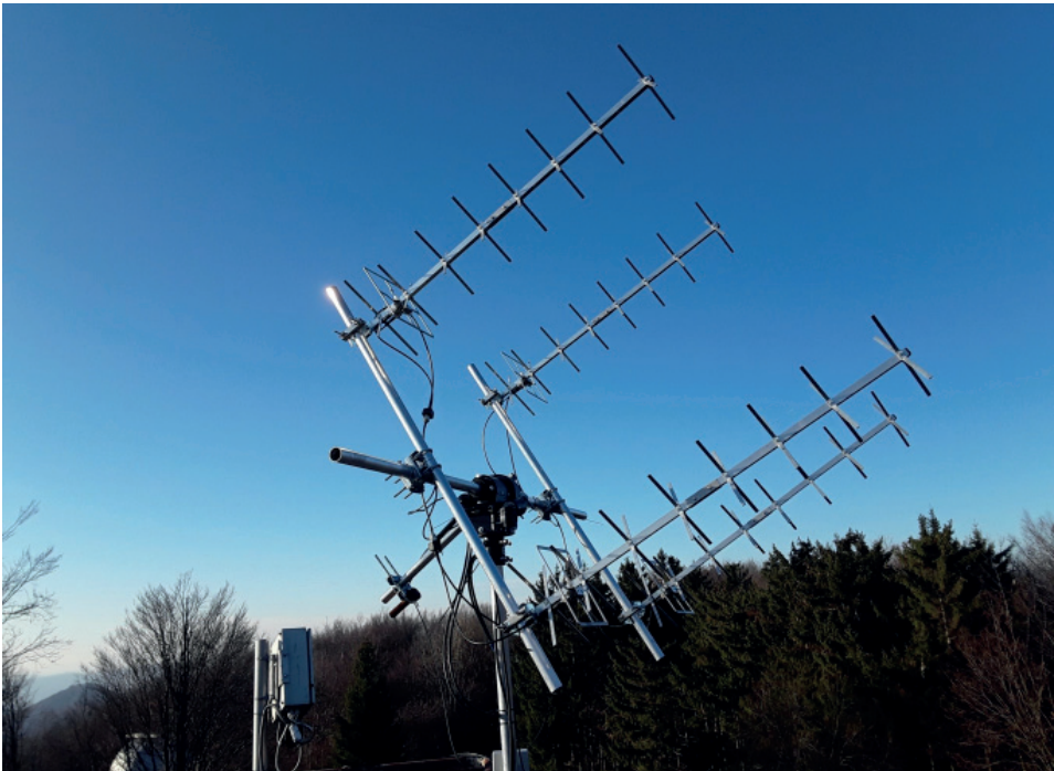
5. ábra: A GRBAAlpha fő vevőállomása, amelyen keresztül a legtöbb adatletöltés is zajlik, a Csillagászati Intézet Pizskéstetői Observatóriumának területén található. A rádiócsendes környezet hatékony üzemeltetést biztosít. (A szerző felvétele)
