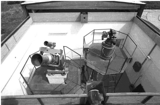
2. ábra Ikonikus bajai műholdészlelő műszerek: AFU75 és DVT
