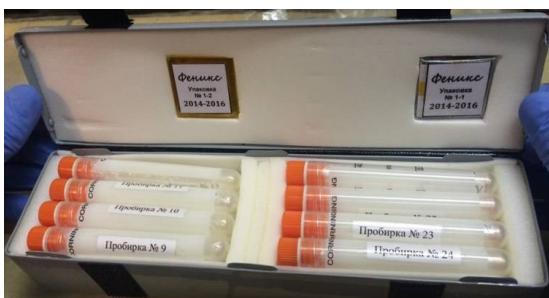
1. ábra: A Főnix program kísérleti egysége. Alul, a mintatartó csövekben sejt kultúrák, míg a fedélen a négyszögletes csomagokban a magyar és az orosz fél sugárdózismérő detektorai foglalnak helyet. (Fotó: IBMP)
