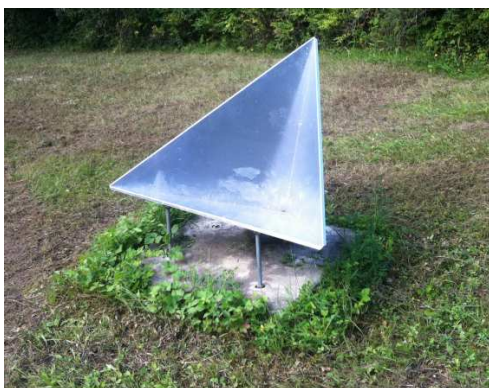
3. ábra: Trihedrális műholdradar-reflektor a FÖMI KGO kertjében
