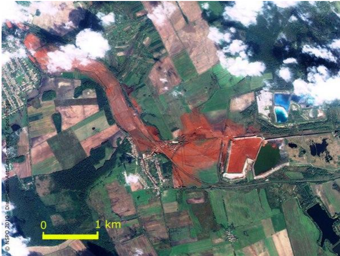
A tajvani FORMOSAT-2 távérzékelő mesterséges október 7-én készítette ezt a felvételt. Látszik az iszapelöntés kiterjedése, s hogy a gát a tározó északnyugati sarkánál szakadt át. A tározóból kiszabadult mintegy 1 millió köbméternyi maró anyag vörös színét legfőbb összetevője, a vas-oxid adja. (Kép: NSPO / Spot Image)
